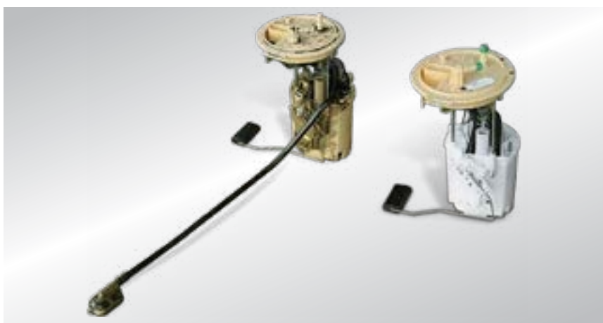
Fig. 2: sinistra: modulo alimentazione carburante montato originariamente con pompa aspirante a getto esterna destra: modulo alimentazione carburante 7.02550.32.0
